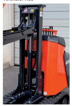
Der Teleskopmast des KC70VHD-4 hebt die Last vertikal an und sorgt für eine ausgezeichnete Standsicherheit.
