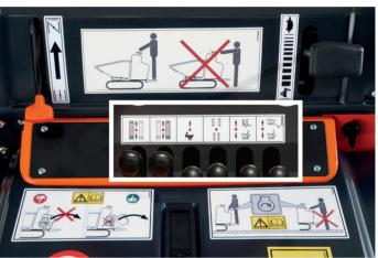
Die Sicherheitsaufkleber sind von der Fahrerposition aus gut sichtbar und dienen dem schnellen und leichten Verständnis der Funktionsweise des Gerätes, damit erhöhen sie die Sicherheit und Produktivität erheblich.
