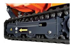
Die Short-Pitched-Gummiketten werden über eine Spanneinrichtung mittels Fettspannzylinder gespannt. Dank dieser Funktion bewahren die Gummiketten eine gewisse Nachgiebigkeit für den Fall, dass Material unter das Raupenband gelangt. Die kurze Teilung des Raupenbands verringert Schwingungen und erhöhte somit den Benutzerkomfort.
