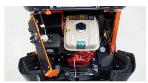
Die Konsole der Benzinmotorausführung kann zur Befüllung des Tanks geöffnet werden. Auch bei der Dieselausführung ist die Betankung einfach.
