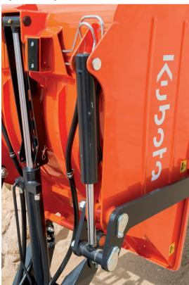
Die Selbstladeschaufel wird über zwei Hydraulikzylinder betätigt, die sich unter der Mulde befinden. Aufgrund ihrer Lage sind sie gut geschützt und verfügen über ein großes Hubvermögen.
