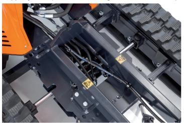
Der verstellbare Unterwagen ermöglicht eine minimale Maschinenbreite von nur 758 mm, bzw. eine max. Verbreiterung auf 1058 mm für eine optimale Standsicherheit.
