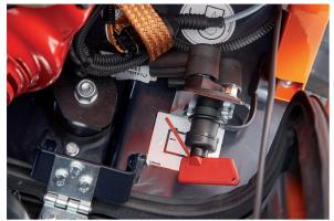
Alle Modelle mit Dieselmotor sind mit diesem Sicherheitsschalter ausgestattet, bei den Modellen mit Benzinmotor besitzen nur die Modelle der Ausführung HD und VHD dieses System.
