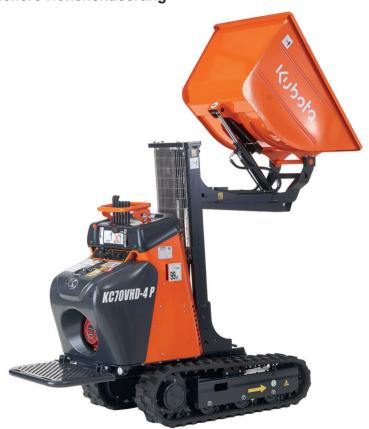
Das teleskopische Hubsystem der Ausführungen HD und VHD gewährleistet bei der Entladung der Mulde eine maximale Standsicherheit.
