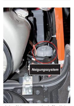
Ab einer bestimmten Höhe der Lademulde und einer Neigung von mehr als 8° ertönt ein akustischer Alarm. Ein Sensor im Motorraum erkennt die Neigung des Rahmens. Am Mast befindet sich ein Mikroschalter für die Hebefunktion der Mulde, der ihre Position erkennt.
