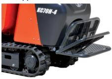
Der KC70-4 ist mit einem einklappbaren Trittbrett ausgestattet. Wenn das Trittbrett ausgeklappt ist, kann der Benutzer sicher aufrecht auf der Maschine stehen. Ist die Trittstufe eingeklappt, verkürzt sich die Gesamtlänge um 214 mm und spart so Platz beim Transport und der Lagerung. Das Trittbrett ermöglicht dem Fahrer ein schnelles Auf- und Absteigen.
