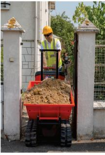
Wie auch alle anderen Modelle sind die KC70HD/VHD-4 besonders für Baustellen in beengten Bereichen geeignet. Der verstellbare Unterwagen ermöglicht die Durchfahrt von engen Passagen (Minimalbreite 758 mm) und gewährleistet eine hervorragende Standsicherheit bei max. ausgefahrener Fahrwerksbreite von 1.058 mm.
