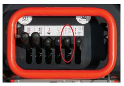
Die Schalthebel werden durch einen Haltebügel geschützt. Alle Bedienelemente sind leicht zu erreichen und zu betätigen. Die Funktionen der Geräte sind unkompliziert und präzise.
