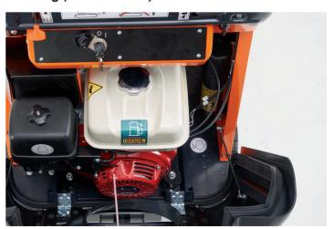
Der Motorhaube kann weit geöffnet werden, so dass alle wartungsrelevanten Komponenten, wie z.B. Kraftstofftank, Luftfilter, Motorölstandanzeiger und die Batterie, schnell und einfach zugänglich sind.
