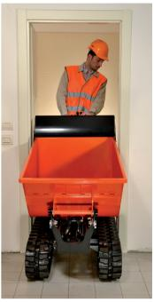
Mit einer Mindestgesamtbreite von 758 mm (in allen Ausführungen) fährt der KC70-4 Ihr Material problemlos durch schmale Türen und Tore, zwischen Gebäuden und Häusern und durch schmale Passagen hindurch.
