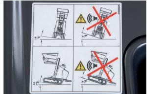
Steht das Gerät mit hochgefahrener Mulde an einem Hang mit einer Neigung von über 8°, ertönt ein akustisches Warnsignal.
