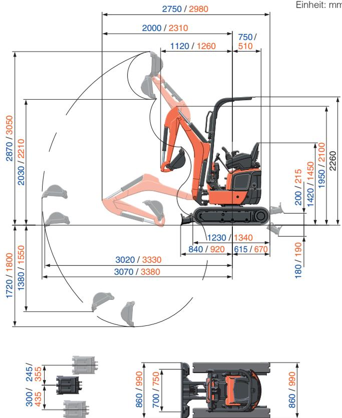
\* Die technischen Daten über den Arbeitsbereich der Maschine wurden mit dem Kubota original - Tieflöfel ermittelt, ohne Schnellwechseleinrichtung.
