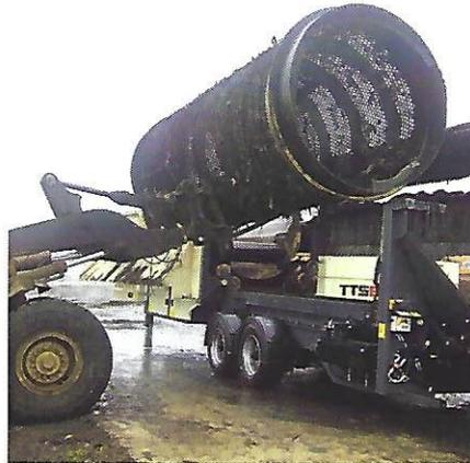
Einfacher Austausch der 5,5 m x 2 m großen Trommel mit Lochplatten – kompatibel mit der Doppstadt SM620 und der Neuenhauser 6020
