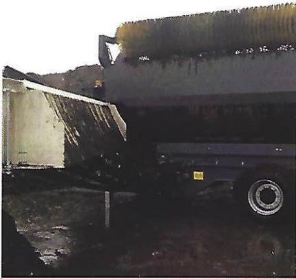
Beidseitiger, uneingeschränkter Zugriff auf die Trommel über zwei große Schwenktüren erleichtert Wartung und Reinigung
