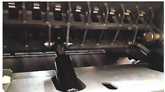
Hydraulisch einstellbarer Gegenkamm zur bedarfsgerechten Anpassung der Produktgröße.
