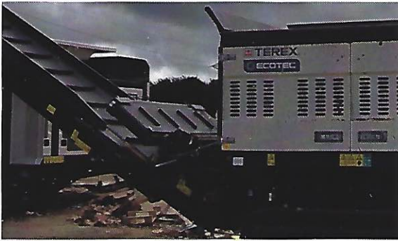
Leistungsstarker Überbandmagnet mit Funktion zum hydraulischen Anheben/Absenken per Fernbedienung, um Blockagen rasch zu beseitigen (optional).
