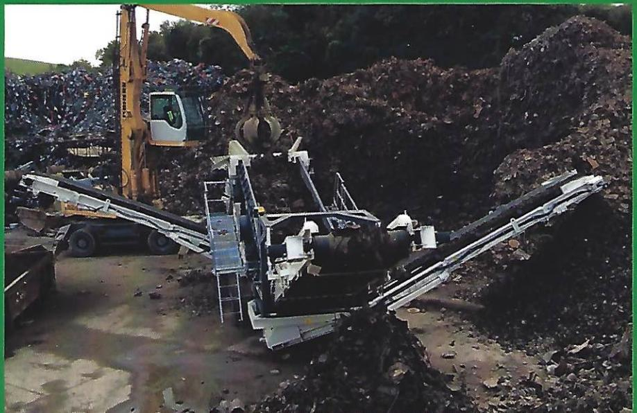
Die raupenmobile Schwerlast-Siebanlage von Terex Ecotec eignet sich für vielfältige primäre und sekundäre Siebanwendungen. Die Terex Recycling-Siebanlage 550 verfügt über ein von Spaleck in Deutschland entwickeltes Doppeldeck-Recyclingsieb mit Spannwellen-Technik. Dieses Hochleistungssieb für Recyclingabfälle und die hochmoderne Technologie des Unterdecks machen die TRS 550 Spaleck-Siebanlage zu einer Maschine der Extraklasse.
