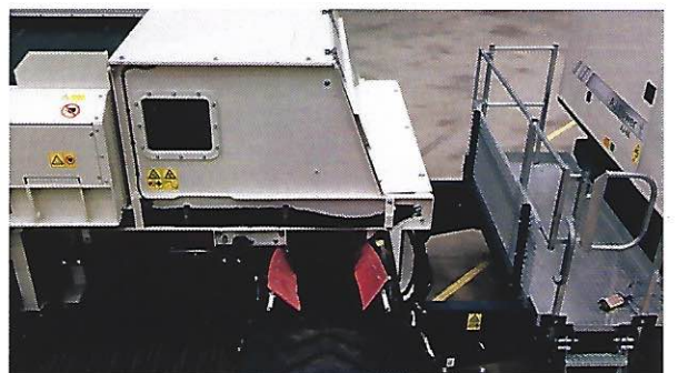
Bewegliche Splitter-Box zur Optimierung des Materialflusses und zum Einklappen der Anlage auf eine Transportbreite von nur 3 Metern. Optimaler Zugang für Wartungsarbeiten.
