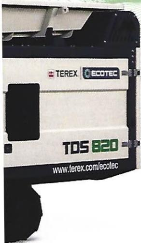
Zu den wichtigsten Merkmalen zählt der hydrostatische Antrieb, der besseren Schutz vor Störstoffen bietet und bidirektionales Schreddern ermöglicht. Der Schredder mit 2 Meter langer Doppelwelle und komplett verschweißten Zähnen zeichnet sich durch hervorragenden Durchsatz und Zerkleinerungsgrad aus. Der durch die unabhängigen Getriebe ermöglichte separate Wellenbetrieb trägt zur Reduzierung von Materialumwicklungen bei und erhöht die Effektivität des Schreddervorgangs.
