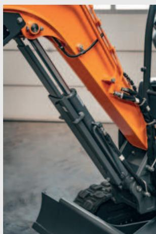
Die Schutzvorrichtungen für Löffelstiel-, Ausleger- und Löffelzylinder halten den härtesten Bedingungen auf der Baustelle stand und gewährleisten die Langlebigkeit und Haltbarkeit Ihrer Maschine.
