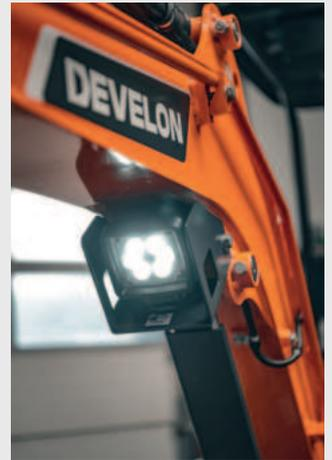
LED-Lampen mit hoher Leuchtkraft sorgen für eine bessere Sicht auf den Arbeitsbereich. So haben Sie die Arbeitsgruppe und insbesondere das Anbaugerät immer gut im Blick.
